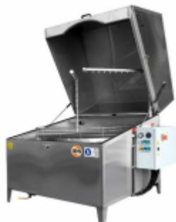
Calentable para productos de limpieza acuosos. Para eliminar la contaminación por aceite y grasa en el menor tiempo posible. De aplicación universal para la limpieza totalmente automática de piezas pequeñas de producción, fabricación, mantenimiento, por ejemplo, pernos, manguitos, rodamientos de bolas.
