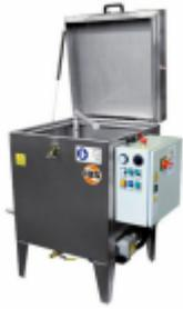
Calentable para productos de limpieza acuosos. Para eliminar la contaminación por aceite y grasa en el menor tiempo posible. De aplicación universal para la limpieza totalmente automática de piezas pequeñas de producción, fabricación, mantenimiento, por ejemplo, pernos, manguitos, rodamientos de bolas.
